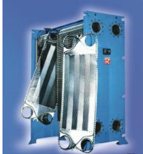
高力組合型板式熱交換不但有各種不同板片，口徑大小範圍最小從 3/4" 至最大的 20"，可依照特定需求，提供多樣的選擇外，更有多種特殊材料之組合型板式熱交換器，鈦 (Ti)、SM0254、鈦氏合金 (C276)、高鎳合金等特殊材質之板片，適用於特殊流體如海水、鹽水、鹽化物、電鍍液、硫酸、鹽酸等酸鹼流體使用，且特殊的紋路設計，即使在低流速時也能造成高紊流，達到高熱傳效能，節省能源的浪費，並可重覆使用，使用年限至少可達 10 年以上，不但替企業節省營運成本，也能響應節能環保。
